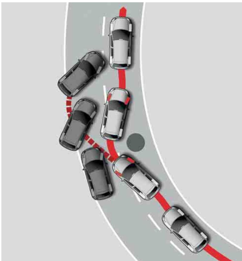
Il **programma di stabilizzazione elettronica (ESP)** impedisce lo sbandamento della vettura nelle situazioni critiche, intervenendo in modo mirato sul sistema di gestione motore e freni.
