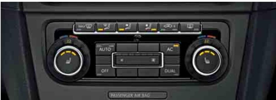
Il sistema di climatizzazione "Climatronic" dispone di regolazione della temperatura separata per il conducente ed il passeggero anteriore. Un sensore rileva la qualità dell'aria attivando, all'occorrenza, il comando di ricircolo.
