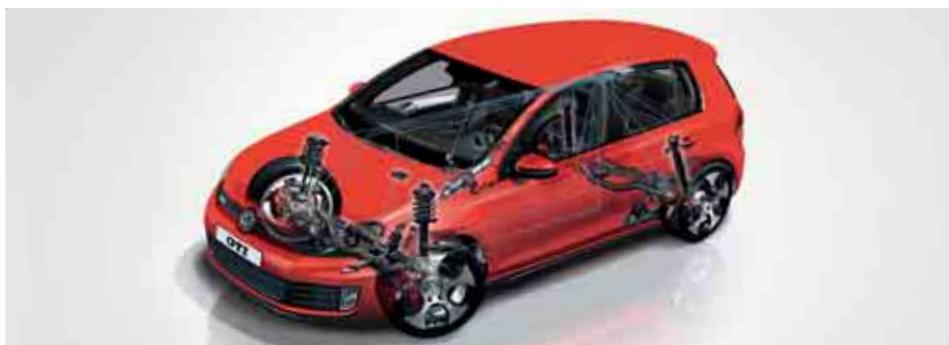
Il **sistema di regolazione adattiva dell'assetto DCC** regola entro pochi millisecondi ogni singolo ammortizzatore in base alle condizioni del manto stradale e della situazione di guida. Premendo un tasto potete decidere l'intensità della regolazione (in modo più rigido o più confortevole), scegliendo tra tre modalità diverse: SPORT, NORMAL e COMFORT.
